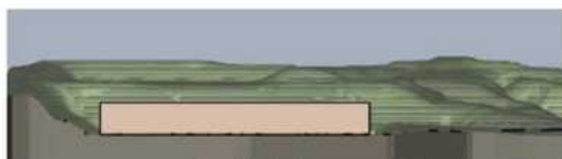
Secció de la nau amb la protecció dels talussos de l'excavació i mota de protecció
