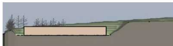
Secció de la nau amb la protecció dels talussos de l'excavació i mota de protecció
