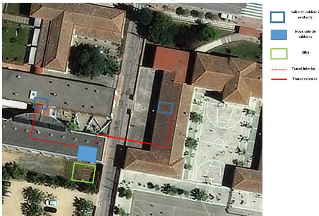
Fig. 10. Futur emplaçament per la sitja d'estella, annexada a la futura sala de calderes
