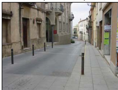
Imatge 3.7: carrer de paviment únic amb separació de pilons
