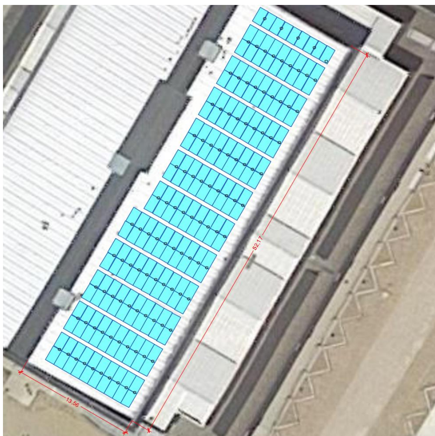
Figura 11. Distribució panells fotovoltaics de la instal·lació
